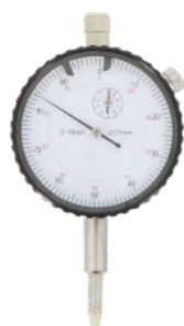
COMPARATEUR 1/100 ÉCO Course 10 mm - Cadran 58 mm Patte fixe
