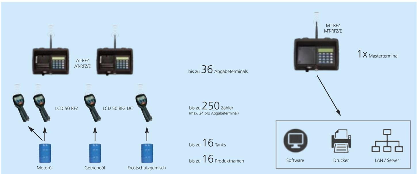
Das Universalsystem "High-End" besteht aus einem Masterterminal, von bis zu 36 Abgabeterminals AT-RFZ, nicht eichfähig oder AT-RFZ/E, eichfähig und bis zu maximal 250 Abgabezählern LCD 50 RFZ oder LCD 50 RFZ DC, beide **nicht eichfähig**, bzw. LCD 50 RFZ/E, **eichfähig**.
