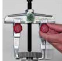
Ermöglicht durch die Handstellrändel ein schnelles Lösen und Verschieben, der Abzughaken auf der Traverse, ohne Schraubenschlüssel.
