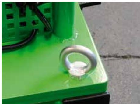
Les anneaux de suspension qui équipent l'extracteur permettent de le déplacer au moyen de systèmes de levage.
