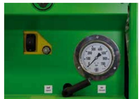
Un manomètre équipe l'appareil pour contrôler la force d'extraction.
