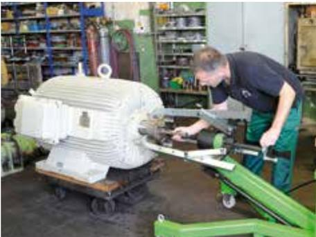
La vis doit être centrée à l'aide de la manivelle, puis solidement pré-serrée.
