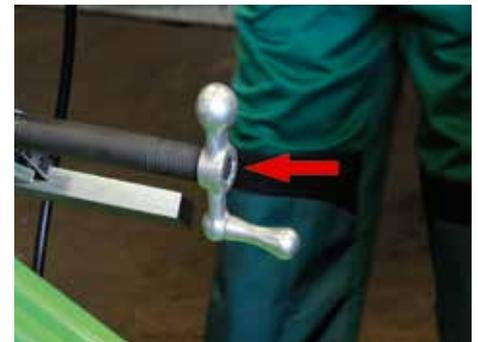
La manivelle est glissée sur le profil carré de la vis. La vis est ensuite centrée à l'aide de la manivelle, puis solidement pré-serrée.
