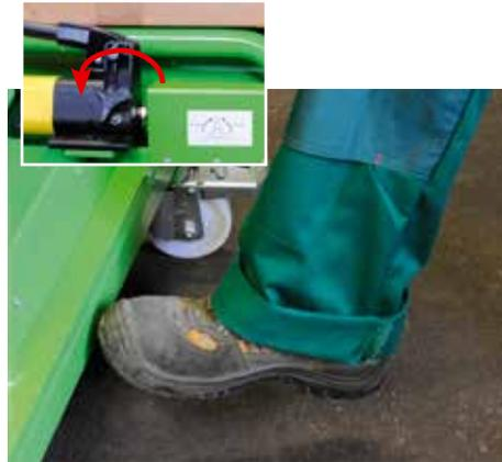
Actionner le pédalier et en même temps, ouvrir la vanne d'arrêt de la pompe à main.
