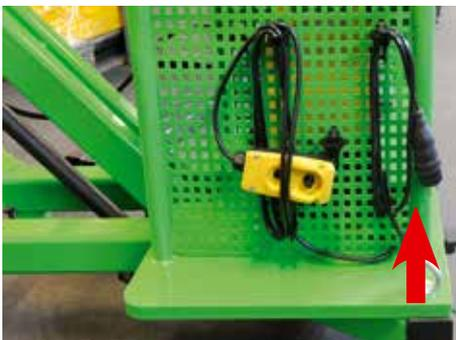
Raccorder le GOLIATH à une source d'alimentation de 230 V à l'aide du câble d'alimentation.
