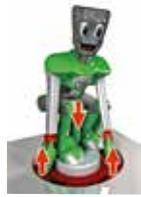
Le roulement à billes est à la fois situé dans un boîtier et sur un arbre.
