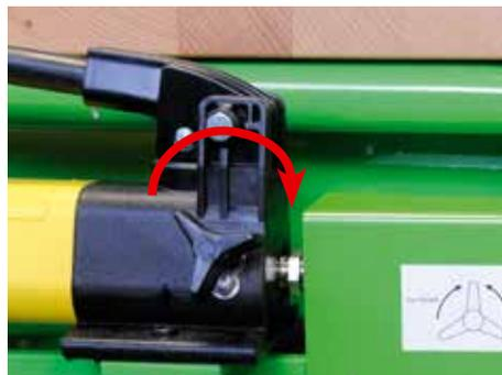
La vanne d'arrêt doit être fermée avant que la pompe à main ne soit actionnée. Close the shut-off valve before operating the hand pump.
