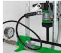
Abziehwerkzeuge mit Hydraulikfunktion.
