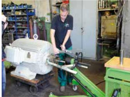
Placer les griffes d'extraction sur la pièce à extraire et serrer à l'aide d'une clef de vis. Attention à placer et à répartir correctement les griffes!
