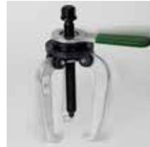
Durch das Drehen der Feststellschraube werden die Abzughaken zentrisch angespannt und greifen so fest um das abzuziehende Teil. Ein Bewegen oder Abrutschen wird so verhindert.
