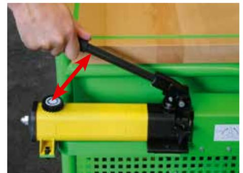
L'actionnement de la pompe à main permet de porter l'extracteur à la hauteur requise.
