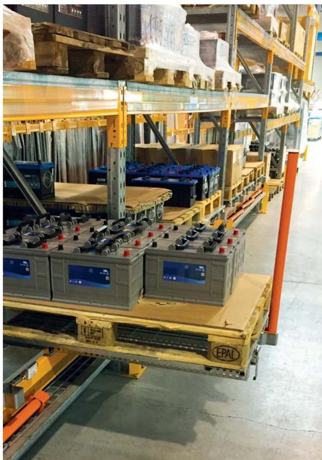
Solution ergonomique d'étagères (ou tiroirs) extractibles sur palettier pour une accessibilité optimale des charges (caisses, cartons, palettes) et éviter les TMS.
