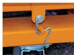
Crochet de sécurité pour verrouiller l'ensemble bac-châssis
