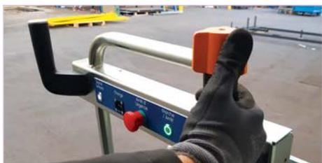
Tableau de commande avec poignée capacitive qui commande la marche avant ou arrière avec le pouce
