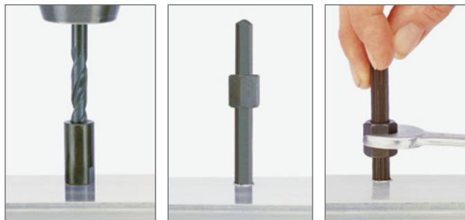
N° 1 percer la vis en se centrànt à l'aide du canon de perçage
