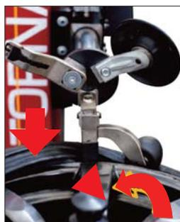
Opération de MONTAGE complet facilitée grâce à l'outil et presse incorporée toujours dans la même position.
