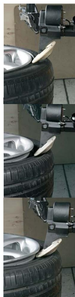
Système de pénétration contrôlée pour simplifier le détalonnage des roues les plus difficiles (Patent Pending).
