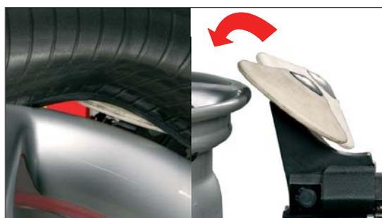
Procédure rapide avec disque détalonneur (conseillée avec des flancs durs) pour le démontage du talon inférieur.
