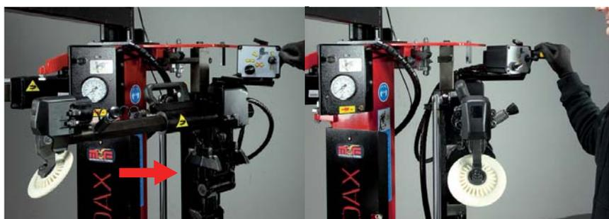
Groupe détalonneur - Ouverture latérale pneumatique du bras pour le positionnement sur le flanc inférieur.
