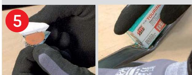
Retirer la protection aluminium de la pièce de réparation, placer la sur la blessure et tout de suite presser fortement
