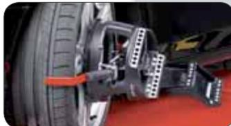
Große Winkel-Reflektoren – für maximalen Lenkeinschlag benötigt.
