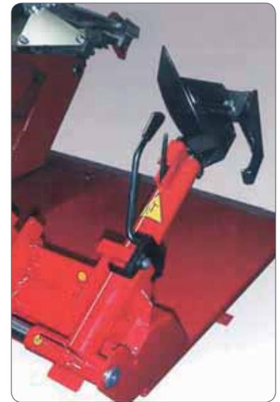
Beim Modell TB 126 N wird die Hubbewegung des Werkzeugarms manuell durchgeführt. Der Werkzeugwechsel erfolgt ebenfalls manuell und die Arretierung wird sichergestellt durch einen Bolzen.
