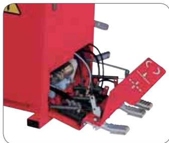
Der Steuerpedalblock kann leicht entfernt werden, um eine optimale Instandhaltung zu gewährleisten.
