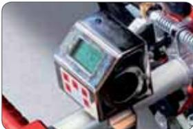
**Inclinometer - elektronischer Neigungswinkelmesser**
