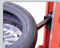
Pneumatisch arbeitender separater Montagearm.
