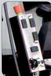
Erleichtert das Bedienen: Drucktasten für die Bewegung der Rollen und Montageköpfe.
