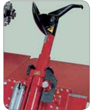
Das Modell TBE 156 N ist mit einem Wulstadrückerarm ausgerüstet, dessen manuell geführte Hubbewegung durch eine Druckfeder unterstützt wird. Die Drehung der Abdrückscheibe erfolgt mit Hilfe eines Einspann- und Lösebolzens.
