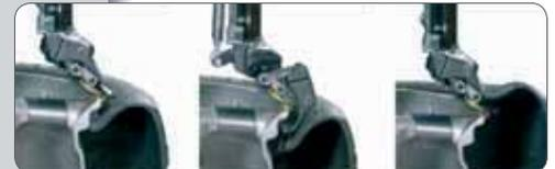
Das Demontagesystem ohne Anwendung des Hebels am Abziehsystem beseitigt jegliche körperliche Belastung für den Bediener und garantiert maximale Sicherheit für Felge und Reifen.
