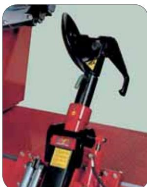
TBE 156 DL verfügt über einen Werkzeugarm mit automatischer Hubbewegung. Die Drehung der Abdrückscheibe wird über ein bequem zu Betätigendes Einspann- und Lösepedal gesteuert. Die simultane Verfahrbewegung wird in 2 Geschwindigkeitsstufen ausgeführt.
