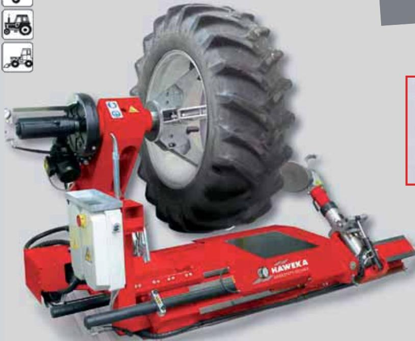
Motor-Drehung bis 2,2 kW und Felgen mit Verlängerungen bis 60 Zoll
