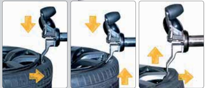
Die Demontage des ersten oberen Wulstes wird durch das Werkzeug mit beweglicher Federbefestigung erleichtert. Dadurch kann problem- und gefahrlos an allen Reifentypen gearbeitet werden.
