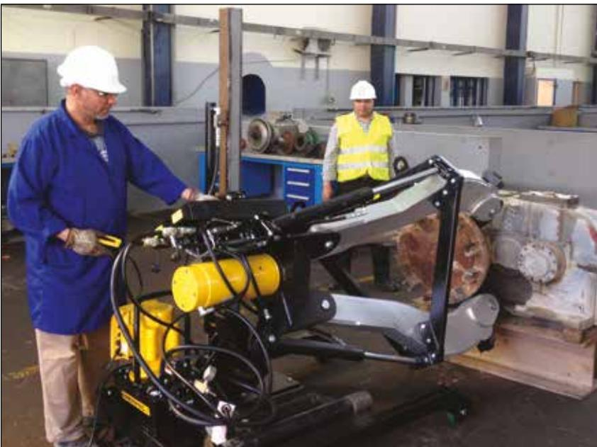
◀ EPH-1003E utilisé dans la maintenance des équipements miniers.
