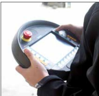
▼ Les techniciens d'amarrage (élingueurs) ont eu recours au système SyncHoist pour contrôler chaque point de levage avec précision, soit indépendamment les uns des autres, soit ensemble de manière synchronisée, afin de positionner le module de 1140 tonnes d'une centrale nucléaire.
