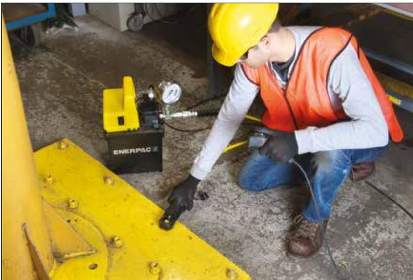
◀ La pompe immergée qui actionne ce casse-écrou permet d'effectuer rapidement et silencieusement ce travail de maintenance.
