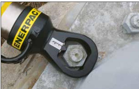
◀ Les écrous très rouillés et usés se cassent et s'enlèvent rapidement grâce au casse-écrou série NS.
