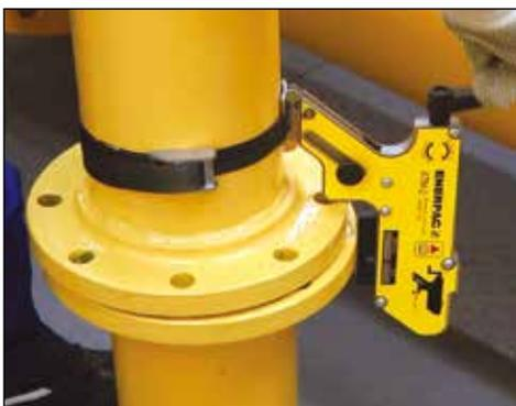
▼ L'ATM-9 apparaît ici avec le manomètre de pression optionnel et son adaptateur.
