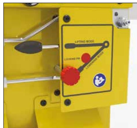
▲ Gros plan sur le mode de commande des vannes de levage-descente et la poignée de verrouillage du Cube Jack.
