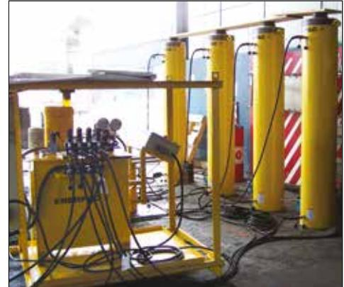
▲ Vérins 500 tonnes double-effet à course de 1,83 m pour levage de pelles électriques à câbles.
