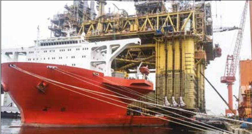
▲ Afin de procéder au super-levage et au lancement d'un système de production de pétrole flottant de pas moins de 43 000 tonnes en Malaisie, pour la plateforme offshore de Gumusut-Kakap, tout a été mis en œuvre pour privilégier la sécurité en utilisant des systèmes hydrauliques synchronisés EVO extrêmement sophistiqués dévolus au levage, à l'équilibrage, au pesage et à la pose tout en délicatesse d'imposantes structures.
