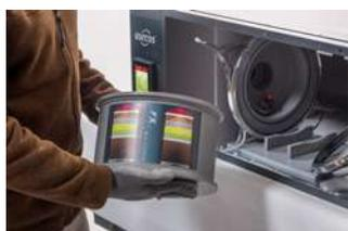
**1** Déballer l'appareil, ouvrir la face avant du boîtier de ventilation et prendre le filtre
