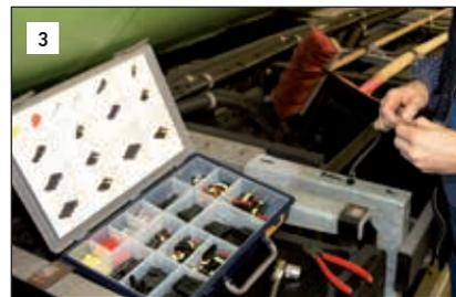
Grâce à la gamme HELLA SUPERSEAL, vous pourrez obtenir un raccord étanche à l'eau et à la poussière au niveau des extrémités de câbles.
