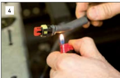
La gaine thermorétractable rend le connecteur étanche à 100 % et évite l'apparition de dommages indésirables dans cette zone. Généralement, la cause de pannes indésirables ne provient pas des produits eux-mêmes mais d'un mauvais câblage.
