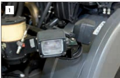
Les Ultra Beam H3 HELLA doivent être remplacés par les nouveaux Power Beam 1500 et Modul 70 pour bénéficier des avantages de la technologie LED HELLA.
