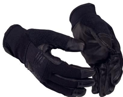
Gant de protection de couleur noire en cuir de caprin plein fleur souple. Grâce à notre technologie CPN®, la paume contient une fine toile métallique qui protège contre les aiguilles et autres objets tranchants. 4 couches dans la paume et 2 couches sur le dessous et le bout des doigts. La manchette se règle facilement à l'aide d'un serrage velcro. Niveau de protection contre les coupures F.
