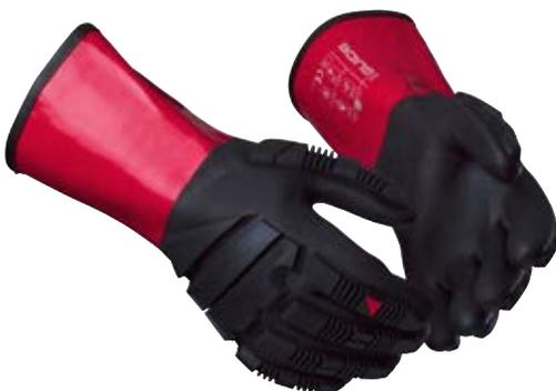
Gant résistant aux produits chimiques, selon la norme ISO374-1 Type A, pour des conditions de travail difficiles. Equipé d'une protection contre les chocs sur le dos de la main, conception ergonomique. Double enduction NBR/PVC étanche aux liquides. Testé pour le niveau de chaleur de contact 2. Niveau de protection contre les coupures C.
