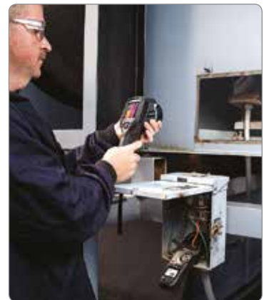
La FLIR CM78 transmet ses mesures électriques aux caméras IR FLIR, par METERLiNK et en temps réel
