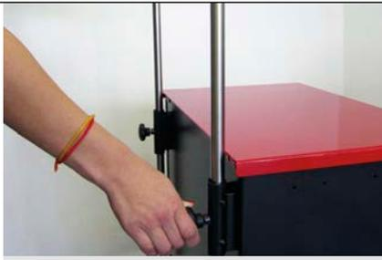
Poignée réglable en hauteur avec une butée d'arrêt
