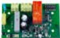
Das **FUNK-230 V Relaismodul** verfügt über einen schaltbaren Steuerausgang (PG-Ausgang). Mit diesem Relaismodul können externe 230 V Geräte vom JABLOTRON 100 Alarmsystem direkt angesteuert und geschaltet werden z. B. Lichtanschlungen, Pumpensteuerungen etc.
