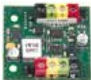
Der **BUS-Isolator** JA-110T dient zur Trennung und zum Schutz der nicht gesicherten Teile der BUS-Verkabelung.
