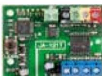
Die **RS-485 BUS-Schnittstelle** dient zur Übertragung von Meldungen, Zuständen und Texten aus dem JABLOTRON 100 Alarmsystem an externe Systeme. Die Übergabe der Daten erfolgt über die serielle RS-485 Schnittstelle.
