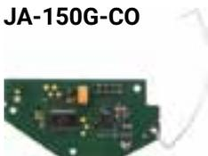
Das **FUNK-Modul** verbindet die Kohlenmonoxidmelder JA-EI208W und JA-EI208DW mit dem JABLOTRON-100 Alarmsystem.
