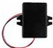
Der **FUNK-Fahrzeugsender** ist für die Montage in Fahrzeugen konzipiert. Mit diesem Fahrzeugsender kann das JABLOTRON 100 Alarmsystem vom Fahrzeug aus direkt bedient und gesteuert werden. So lassen sich z. B. durch das Bestätigen der Fernlichtes Garagentore etc. öffnen oder ein Sicherungsbereich kann scharf / unscharf geschaltet werden. Der Fahrzeugsender wird mit 12 V - 24 V direkt vom Fahrzeug versorgt.
