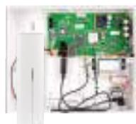
mit integriertem 3G-GSM/GPRS/LAN-Kommunikationsmodul und dem JA-111R Funkmodul (868 MHz). Durch die 3G-Version des GSM-Moduls wird eine schnellere Übertragungsgeschwindigkeit von Daten und Bildern gewährleistet.
