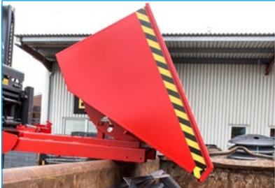
Ces bennes possèdent non seulement un système de basculement dérouleur mais également un déverouillage automatique. En posant ou en prenant appui sur le bord de votre benne de collecte, vous déclenchez le basculement de la benne. Un déclenchement du basculement par câble n'est plus nécessaire.
