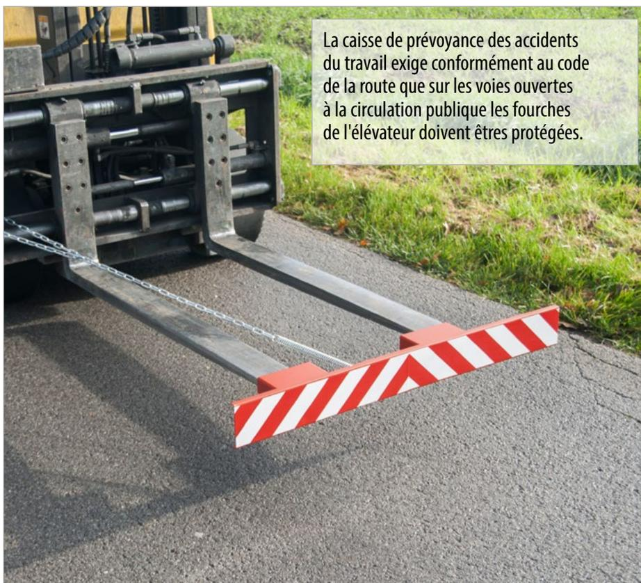
La caisse de prévoyance des accidents du travail exige conformément au code de la route que sur les voies ouvertes à la circulation publique les fourches de l'élévateur doivent être protégées.
