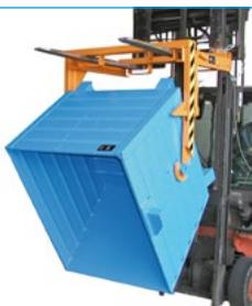
Ces bennes n'ont pas de mécanisme de basculement intégré et sont de ce fait une alternative attractive à petit prix. Indépendamment du nombre de conteneurs utilisés à largeur identique, un seul palonnier de vidage est nécessaire. Pour les bennes sans tourillons, un chariot élévateur à tête rotative est nécessaire pour effectuer le vidage.
