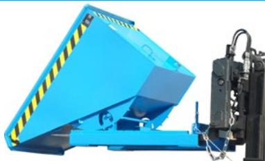
Bennes basculantes à système dérouleur pour un vidage simple ainsi qu'un retour en sa position initiale automatique. Grâce à son centre de charge avantageux, la charge utile totale du chariot élévateur peut être utilisée et le déclenchement du basculement se fait par câble du poste de conduite du cariste même en grande hauteur.
