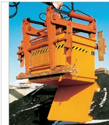
BC avec déverrouillage du fond par pinces lève-blocs
