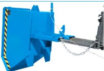
De part sa conception compacte et son hauteur réduite, cette benne vous permet un volume de remplissage optimisé et grâce à son mécanisme de basculement idéal un vidage total. Le basculement se fait rapidement par le système de déblocage par câble. Il est également possible de la vider en posant le bac de la benne sur le rebord du contenant, de déclencher et de faire monter doucement le mat.
