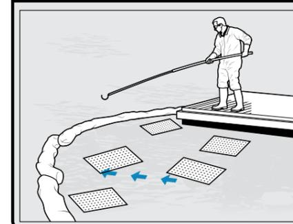
Placez les barrages en aval en leur permettant de flotter librement ou dans le sens de l'écoulement de l'eau pour canaliser l'huile.
