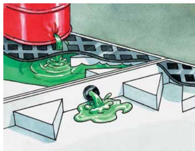
Les raccords de cloisons brevetés permettent aux plates-formes connectées de partager la capacité du puisard.
