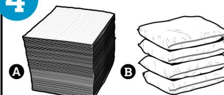
Utilisez les absorbants **A** pour une couverture maximale et les coussins **B** pour un pouvoir absorbant maximal.
