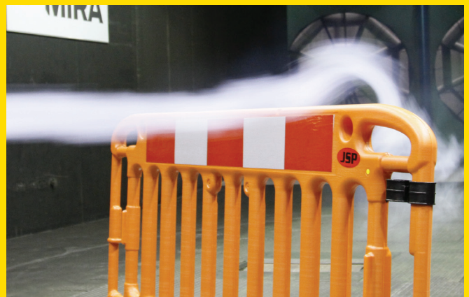
La fumée est utilisée pour contrôler le flux d'air et visualiser toute la portée du mouvement d'air autour de la barrière.
