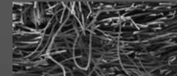
fibres solides et plus nombreuses **augmentant le poids** | structure 2D plate en couches superposées **empêchant l'air de pénétrer** | **perte de capacité d'isolation** quand comprimé | agglomération de fibres limitant la flexibilité et la souplesse
