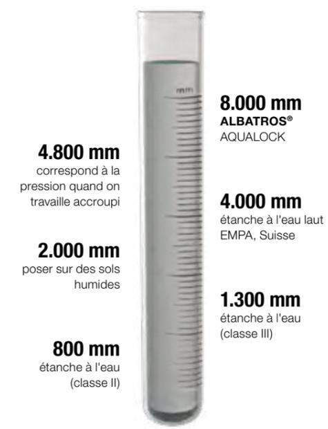
La colonne d'eau sert d'unité de mesure. Elle permet d'indiquer l'étanchéité d'un matériau.
