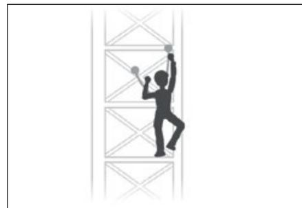
Les longes à deux brins ABSORBICA-Y permettent de rester assuré lors du passage d'un fractionnement, en déconnectant puis reconnectant successivement les deux brins.
