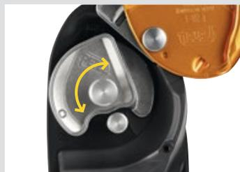
La came pivotante facilite le coulissement de la corde dans l'appareil lorsque l'utilisateur ravale le mou ou effectue une courte remontée sur corde.
