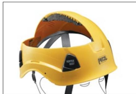
Les casques VERTEX disposent d'une coiffe en textile six points, épousant la forme de la tête pour un maximum de confort. L'absorption des chocs est réalisée par déformation de la calotte. Poids : 455 g
