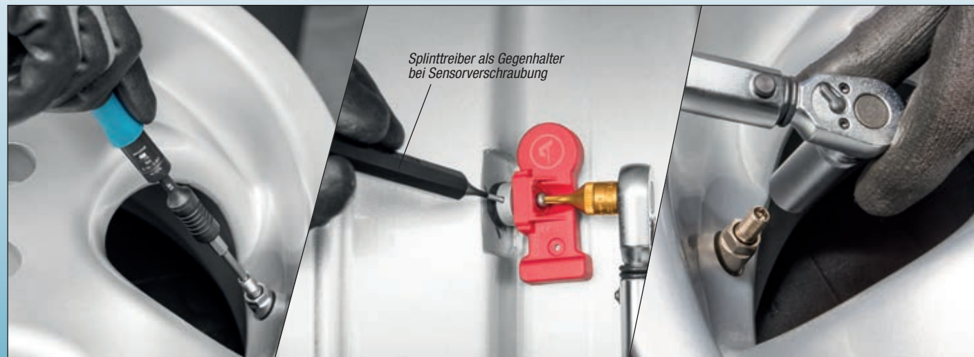
Ventileinsatz eindrehen 0,1 – 0,6 Nm
